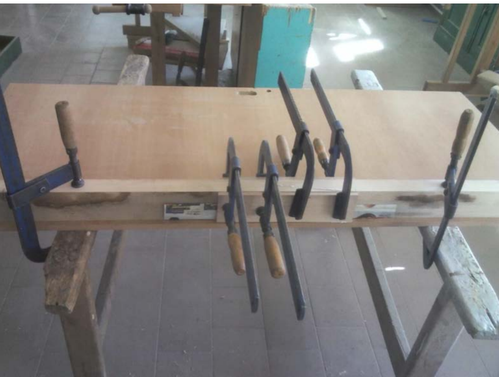
● OBR. 5: LEPENÍ LUBOVÝCH LATÍ (JINÝ MATERIÁL, ALE ÚPLNĚ STEJNÝ PRINCIP)
