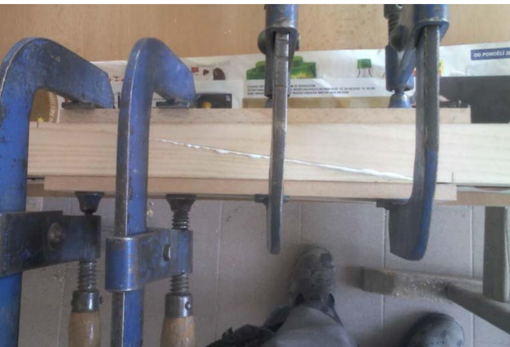
● OBR. 6: LEPENÍ SAMOTNÉHO SPOJE
